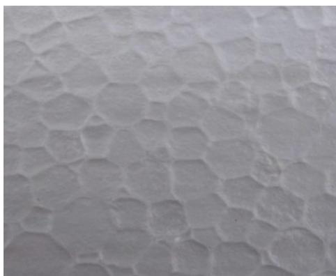
Oberfläche einer EPS-Dämmstoffplatte (Waben)
